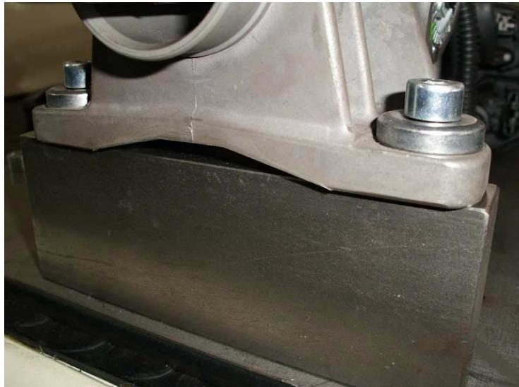
Assemblare il Tool#1 (piastra principale) e i due pezzi Tool#3(supporto verticale per Golf V) e montare l' EPS sul supporto bloccandolo con vite M8x20.
