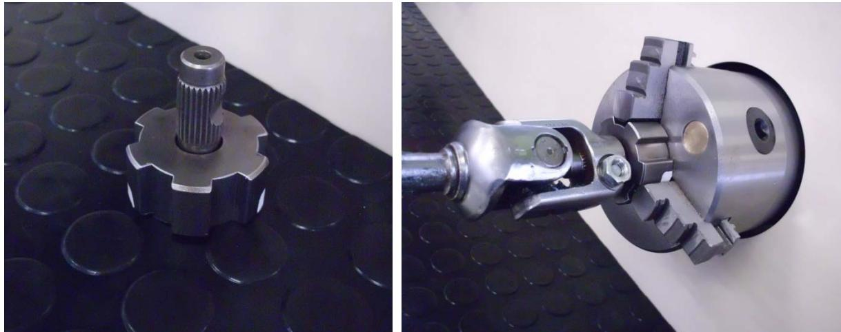
Couvrir l'arbre et le mandrin avec les gardes de sécurité et de verrouiller à l'aide de deux vis.
