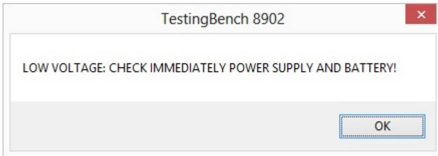
La tensione DC viene impostata mediante alimentatore DC e una batteria da 100Ah. È possibile regolare la tensione tramite il potenziometro che si trova nell'unità di alimentazione. Si consiglia di impostare tra 13Volt e 13.5 Volt.
