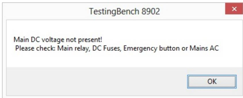
Il testing bench verifica che la tensione DC sia dentro ai valori che vanno dai 12 Volt ai 15 Volt, se invece il valore è fuori questo campo apparirà uno dei seguenti messaggi (Low voltage or Over voltage):
