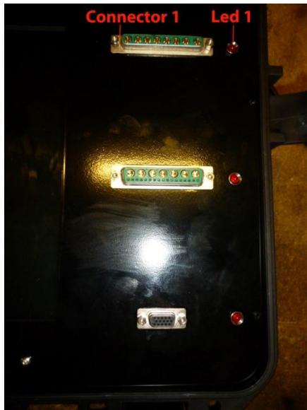
A questo punto aprire la pagina del modello che si intende testare e collegare il relativo cavo nel 'connector 2' che si trova subito sotto al connettore della batteria. Il Led 2 si accenderà solo dopo aver dato il Power Supply ON.
